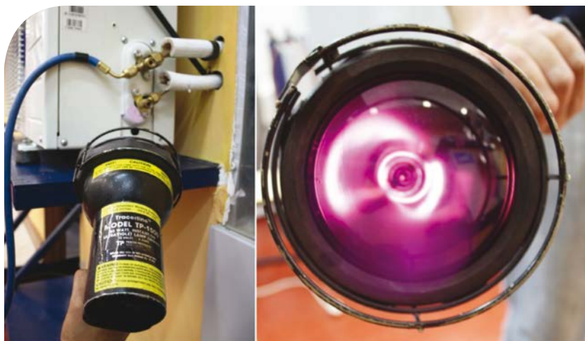
Foto 22. Método directo con trazadores visibles con rayos UVA.
