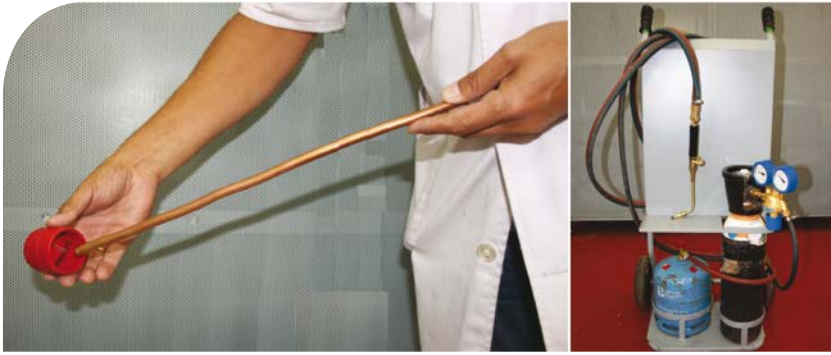
Foto 6. Escariado (izquierda); Equipo de Soldadura Oxigás (derecha).
